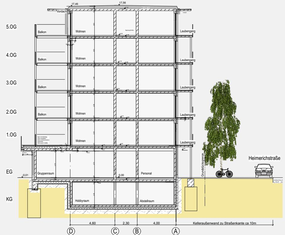
Schnitt 2-2 durch 5-geschossigen Bereich
